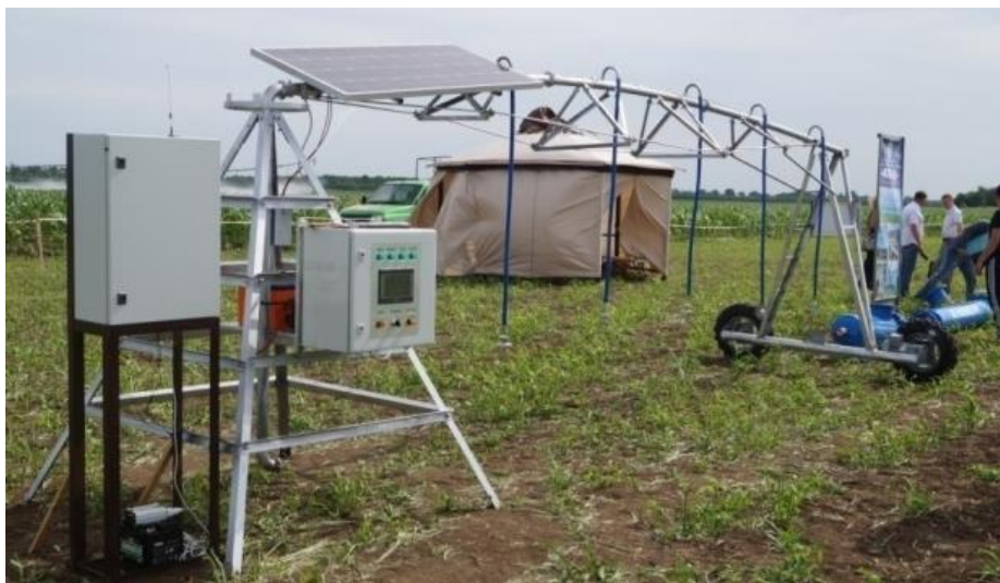
Рисунок 3.6 – Лабораторный стенд секции дождевальнoй машины в условиях УНПО «Поволжье» (с. Степное Энгельсского р-на Саратовской обл.)
