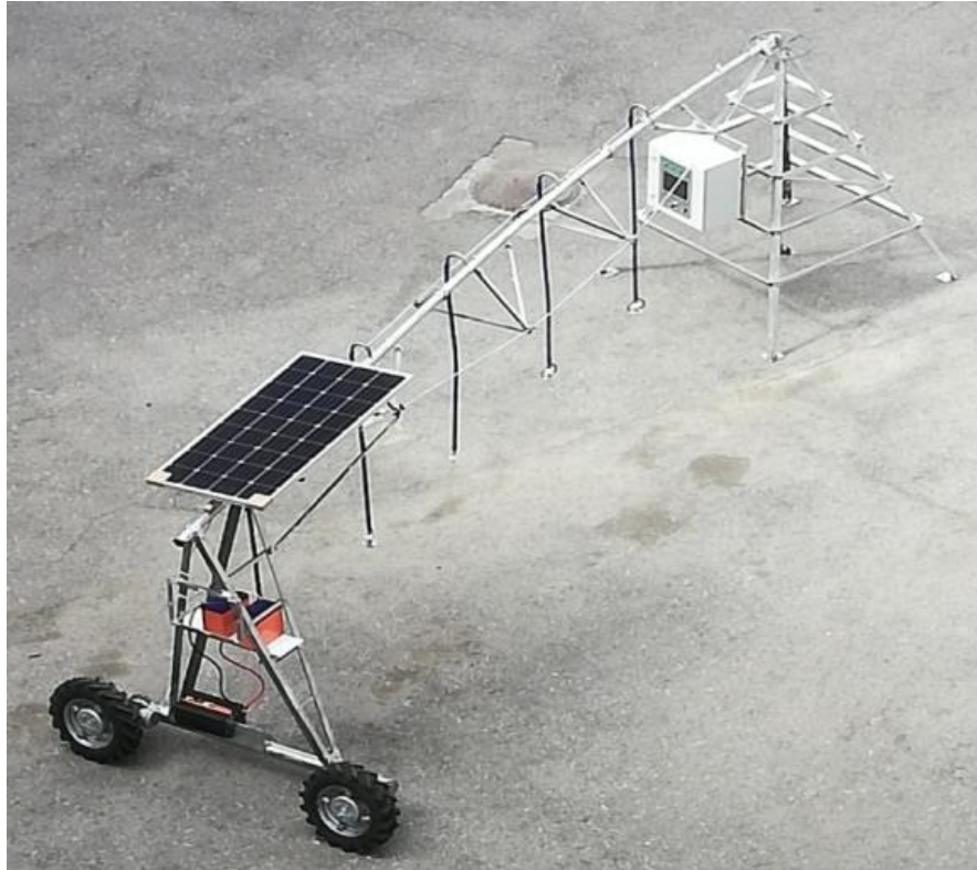
Рисунок 3.2 – Лабораторный стенд секции дождевальной машины кругового действия (вид сверху)
