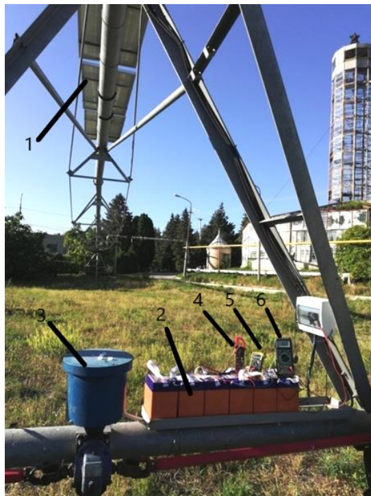
Рисунок 3.4 – Общий вид лабораторного стенда для испытаний источника питания в виде САБ: 1 – солнечные батареи; 2 – аккумуляторы Delta GEL 12-55; 3 – вентильно-индукторный электродвигатель (мотор-редуктор); 4 – измеритель емкости заряда АКБ; 5 – мультиметр 1; 6 – мультиметр 2
