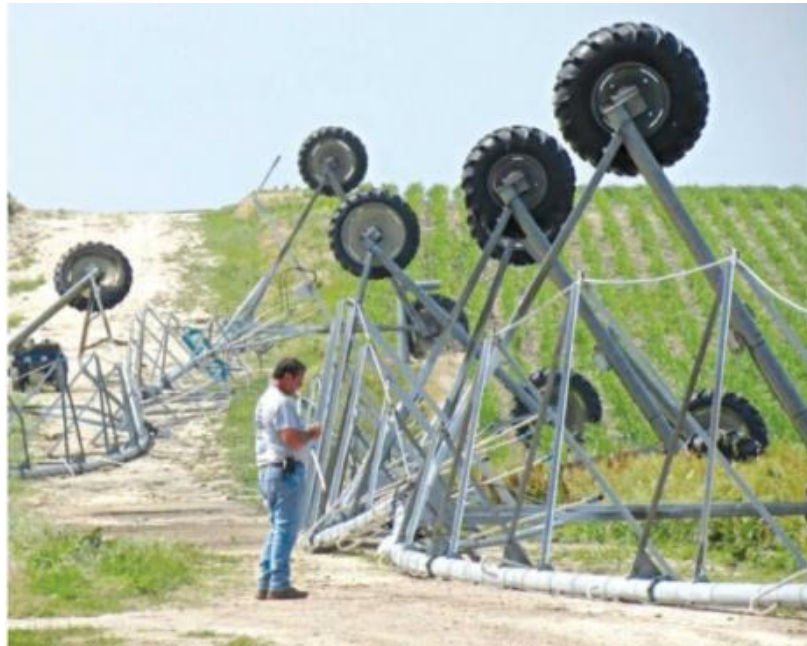
Рисунок 1.7 – Последствия действия сильного ветра при эксплуатации ДМ на поле с уклоном
