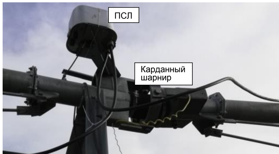
Рисунок 1.8 – Карданный шарнир, соединяющий секции между собой, подвержен изломам и изгибам при действии сильного ветра
