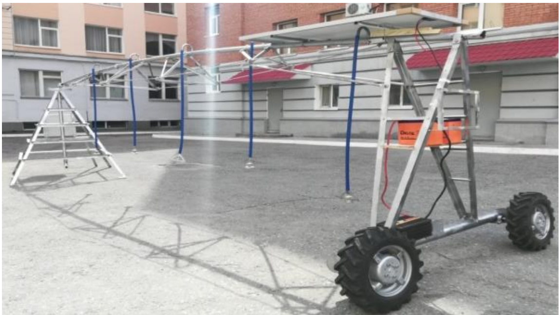
Рисунок 3.3 – Лабораторный стенд секции дождевальной машины кругового действия (вид сбоку)
